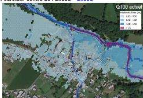
Figure 8 : Extrait de la cartographie de l'effet du barrage sur le centre-bourg d'Escou pour la crue centennale de l'Escou
