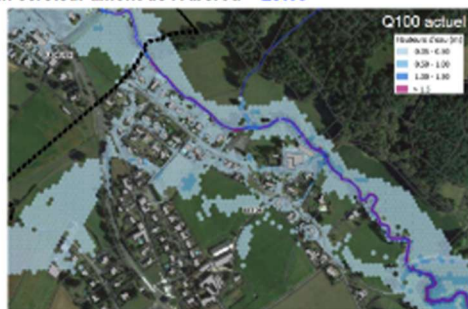
Figure 22 : Extrait de la cartographie de l'effet du barrage sur le centre-bourg d'Estos pour la crue centennale de l'Abérou
